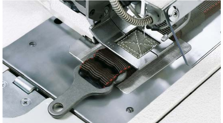
Riegel an Lastengurten mit Nahtbild F 72-2 (72 Stiche); Nähzyklus: ca. 7,5 Sek. Backstitches in a cargo belt with seam pattern F 72-2 (72 stitches); sewing cycle: approx. 7,5 sec.
