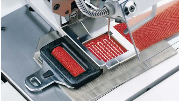
Riegel an Sicherheitsgurten mit Nahtbild F 116-15 (116 Stiche); Nähzyklus: ca. 10 Sek. Backstitches in a safety belt with seam pattern F 116-15 (116 stitches); sewing cycle: approx. 10 sec.
